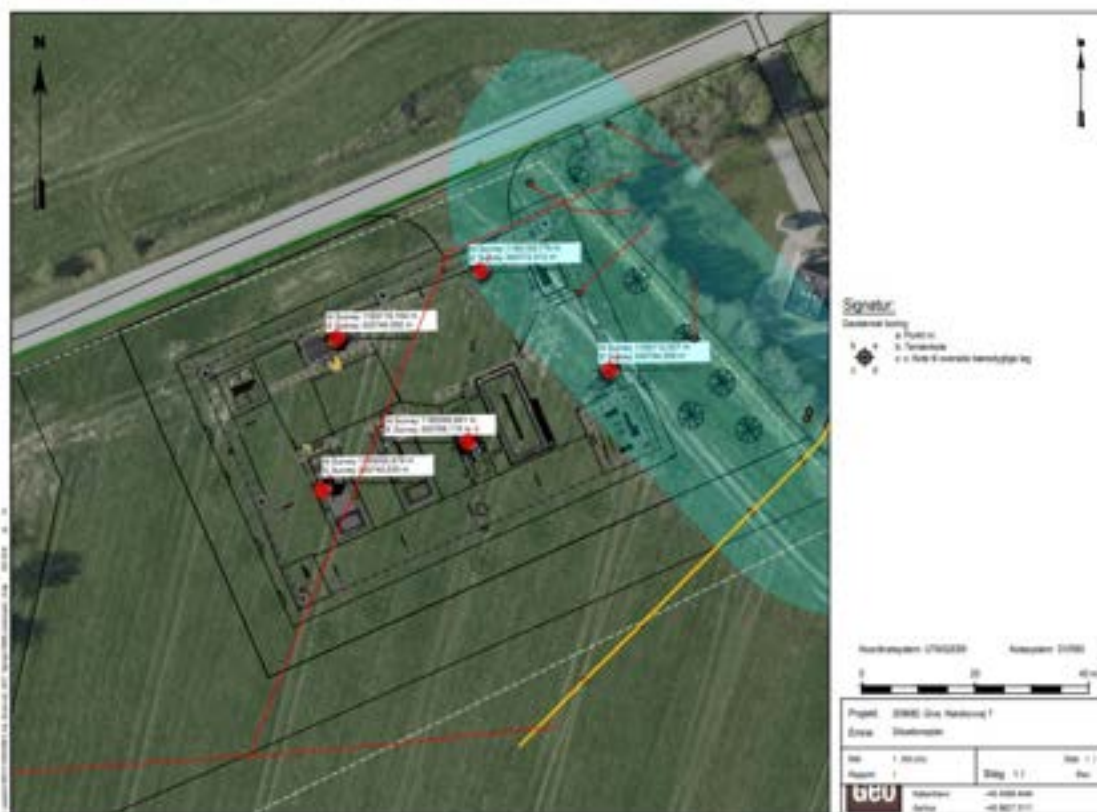
Figur 2-1: Oversigtskort over borerig ifm. geoteknisk undersøgelse i juni 2025.
